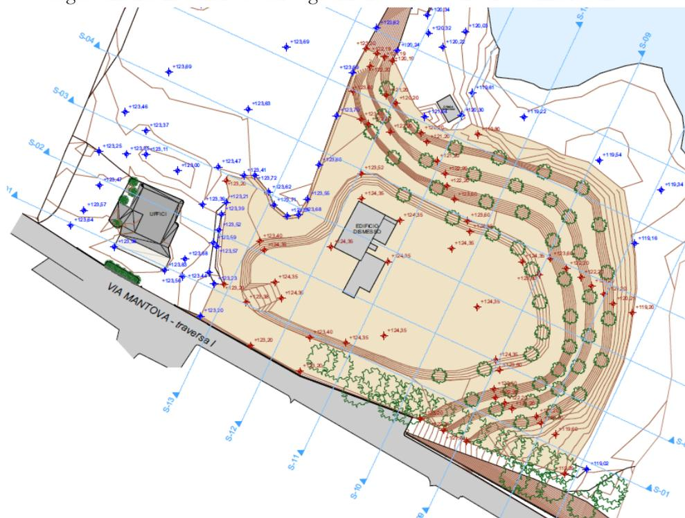
**Per la corretta progettazione dell'intervento di colmatare** è stato eseguito un rilievo topografico del lotto comprensivo di alcune quote presso i lotti vicini. In particolare si è ritenuto necessario rilevare anche la porzione oggetto di colmamento autorizzata con Permesso di Costruire e Proroga sopra citati al fine di verificare lo stato di fatto e correlare il nuovo progetto di colmamento alle quote di progetto precedentemente autorizzate.
