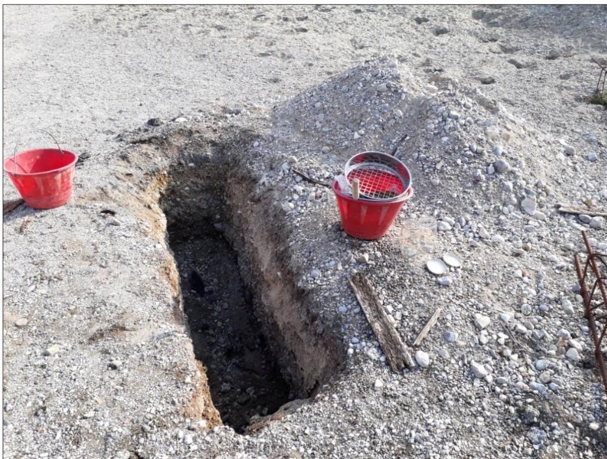
Fig. 2 - Operazioni di prelievo del campione di terreno mediante setacciatura della frazione >2 cm, raccolto con una spatola metallica a seguito di preventiva miscelazione e quartatura, e posto in un vaso di vetro del volume di 1,0 l.
