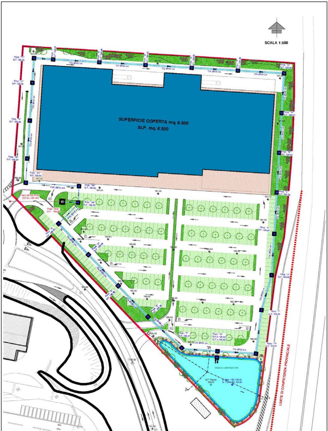
Sistema di Laminazione il linea - Collettore perimetrale - Laghetto
