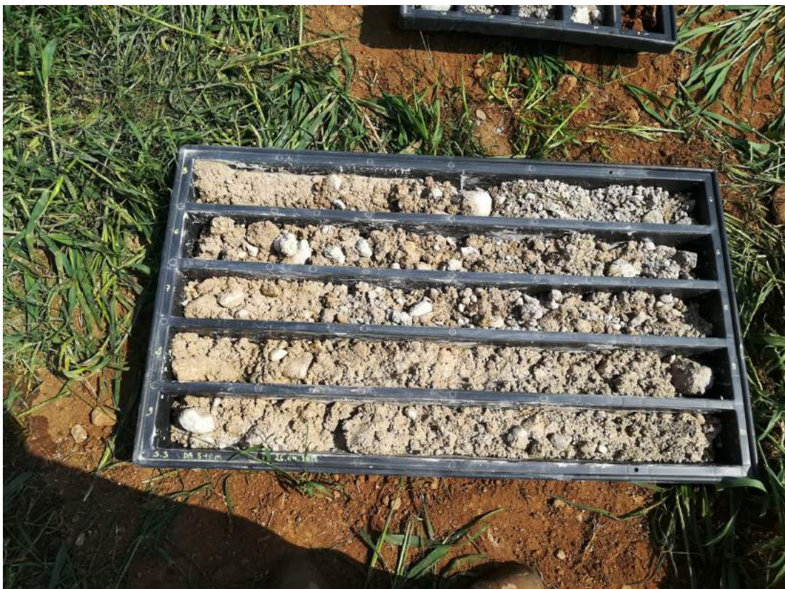
SONDAGGIO S3 – Cassa n.2 da 5.00 m a 10.00 m
