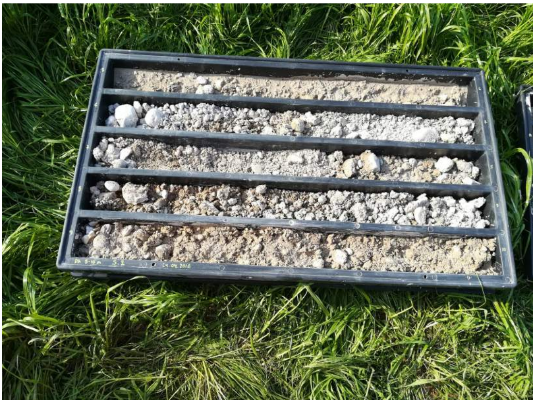
SONDAGGIO S2 – Cassa n.2 da 5.00 m a 10.00 m
