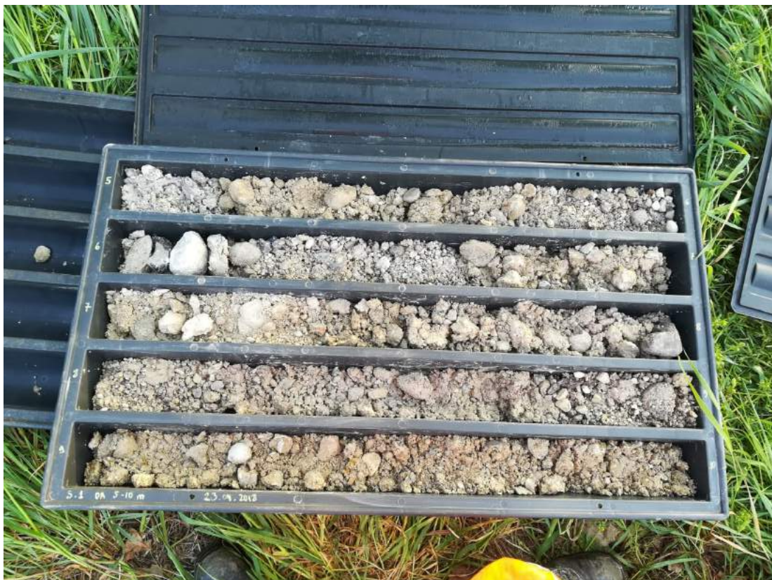
SONDAGGIO S1 - Cassa n.2 da 5.00 m a 10.00 m
