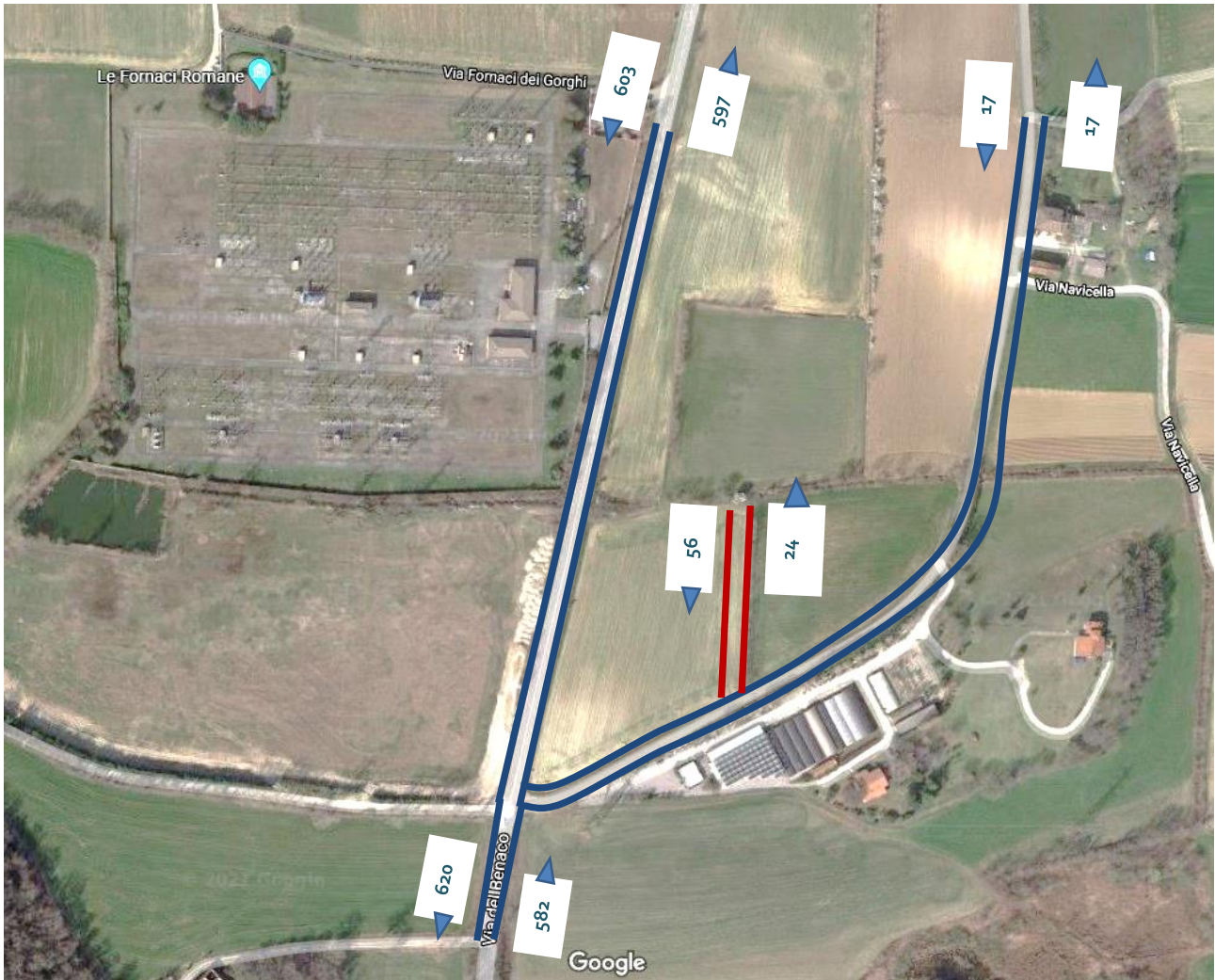
Figura 35 – Scenario di progetto, flussi veicolari attesi nell'ora di punta serale (vph eq)
