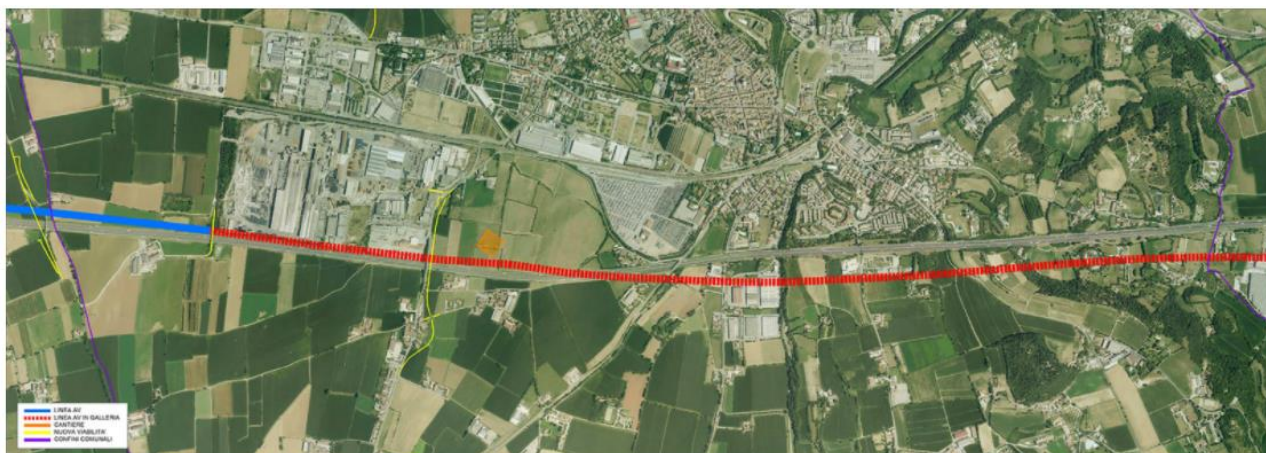
Figura 29 – Tracciato linea AV nel comune di Lonato del Garda (fonte Cepav Due)
