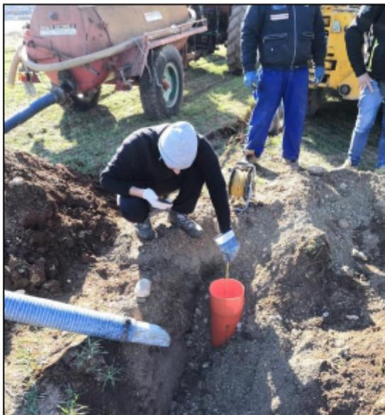
*Fig. 8 - Esecuzione di prova di permeabilità in sito.*
