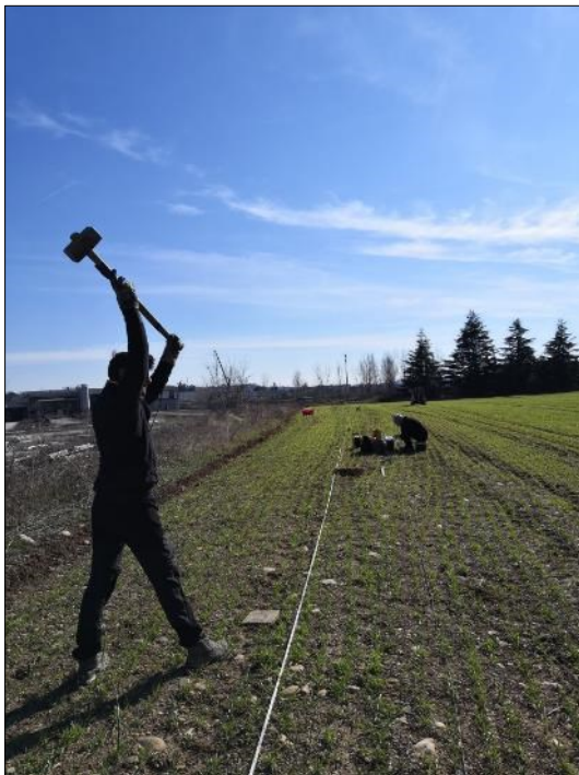
Shot sismico verticale per la generazione delle onde di Rayleigh (Offset 8 m)
