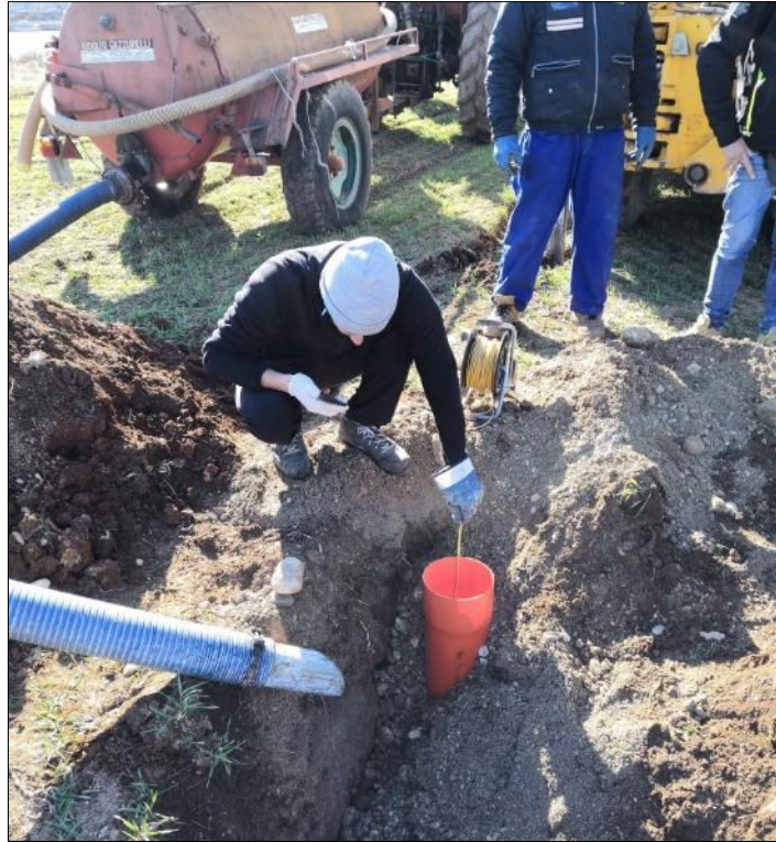
Fig. 8 - Esecuzione di prova di permeabilità in sito.
