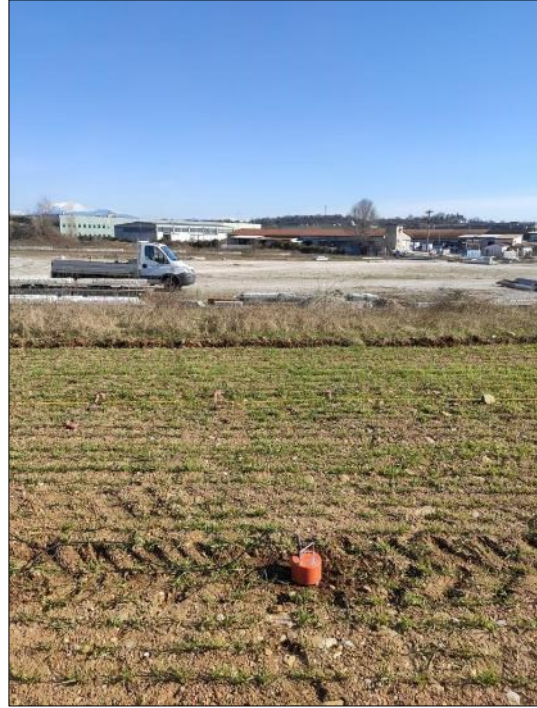
Acquisizione del microtremore sismico mediante tecnica HVSR
