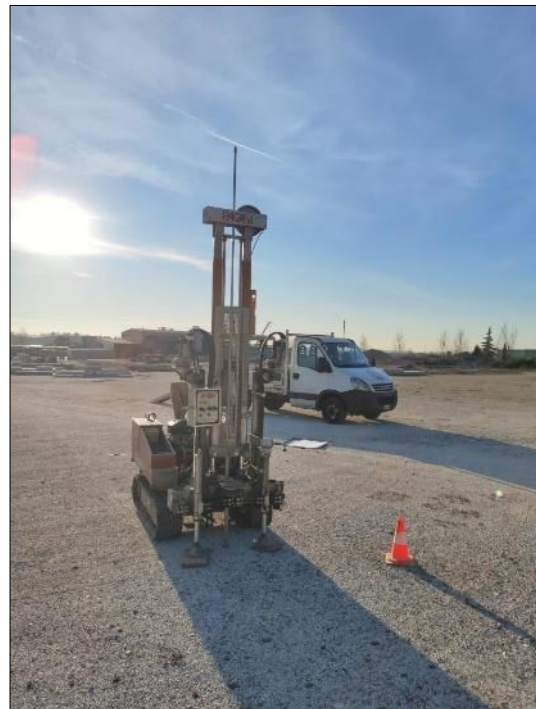
Esecuzione Prova Penetrometrica P1
