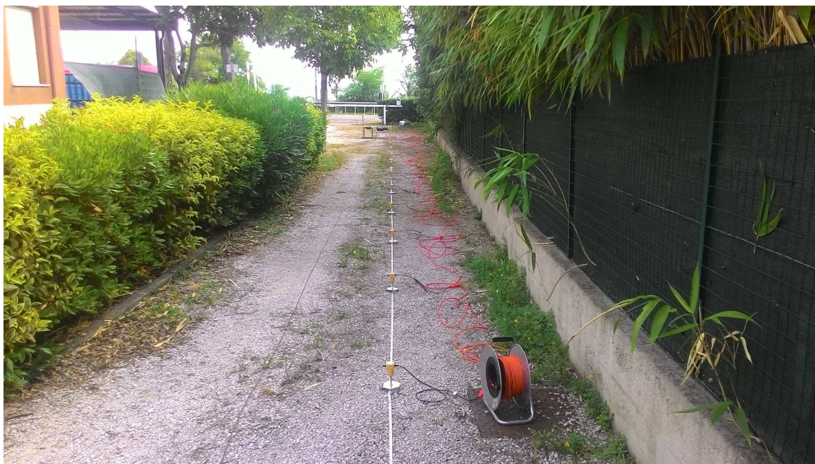
Fig. n.21 – Posizionamento dello stendimento sismico visto da sud-ovest
