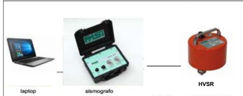
Lo strumento è in grado di acquisire simultaneamente sui 3 canali. La gestione del sismografo avviene tramite software proprietario installato su laptop, tramite il quale è possibile gestire tutte le operazioni di campagna attraverso le seguenti fasi:
