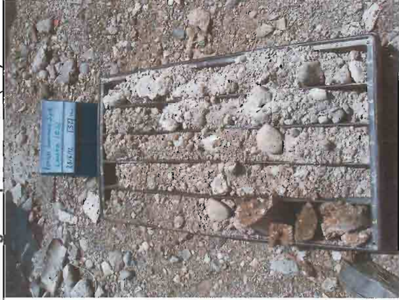
Foto n.5 Vista delle carote estratte dal Sondaggio S.2 0 - 5 m
